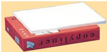
Un posible método es medir el grosor de un conjunto de folios. Contar cuántos folios hay y luego dividir el espesor total obtenido entre el número de folios.
